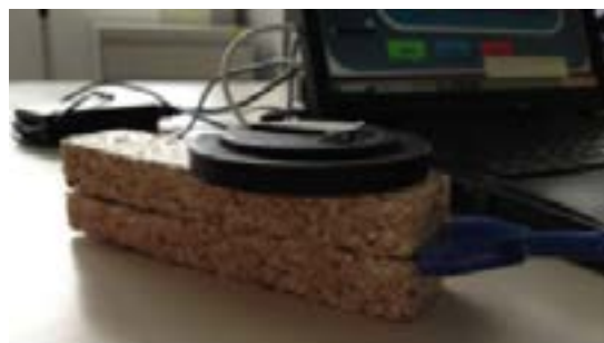
Mesure de conductivité thermique dans un composite biosourcé
